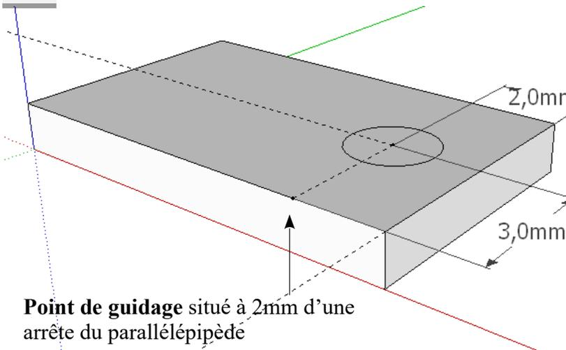
**Point de guidage** situé à 2mm d'une arête du parallélépipède
